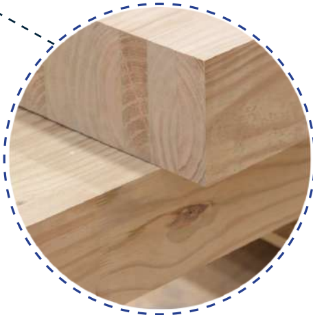
Estrutura (pilares, vigas e madeiramento do telhado) em Madeira Laminada Colada (MLC)
